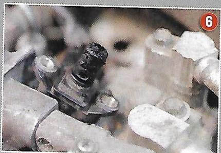
zpětné vedení výfukových plynů do sání (EGR). I když funguje bezvadně, způsobuje zarůstání sání karbonem. Jak moc, záleží na konstrukčním řešení každého motoru – důrazem na homogenizaci, různým vylepšováním ejektorů a vření se konstruktérům v průběhu let dařilo tyto jevy omezovat.
