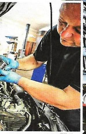
**Nová metoda umí vyčistit filtr pevných částic přímo na autě bez nutnosti demontáže.**
