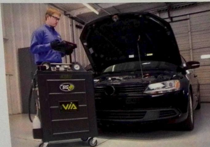
a výše. Existuje však i druhá cesta, která majiteli takto postiženého vozu nabízí daleko jednodušší, bezdemontážní a cenově výhodnější formu vyčištění DPF filtru. Velmi progresivní je v tomto směru americká technologie BG Products, která dokáže s pomocí speciálního stroje za cca 3 hodiny bezdemontážně chemicky vyčistit DPF filtr, jehož emisní hodnoty se po zákroku vrací téměř na úroveň nového filtru.
