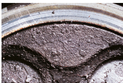
Spalovací prostor před dekarbonizací
