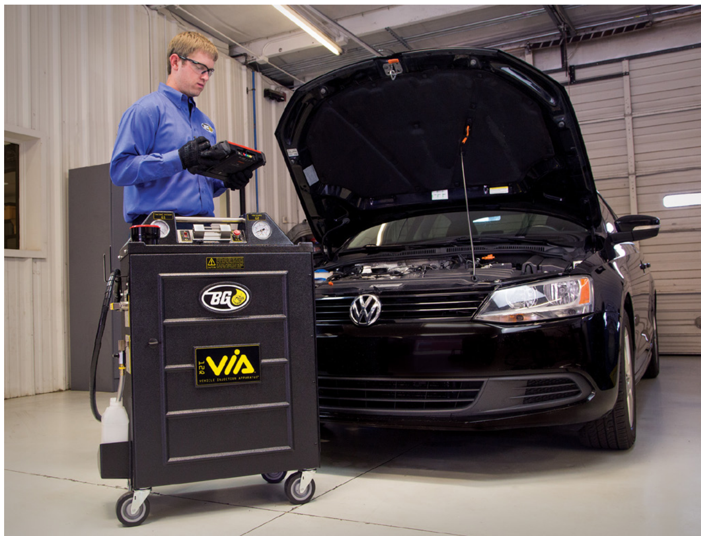
Čištění filtru pevných částic (DPF) bez demontáže z vozidla
