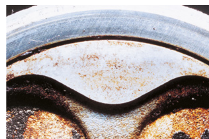
Spalovací prostor po dekarbonizaci
